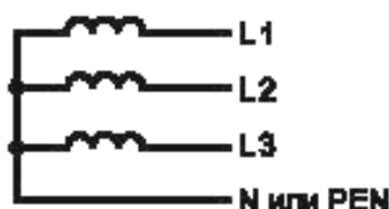
Рисунок 5 – Трехфазная четырехпроводная электрическая цепь
