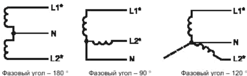
Рисунок 2 – Однофазная трехпроводная электрическая цепь
