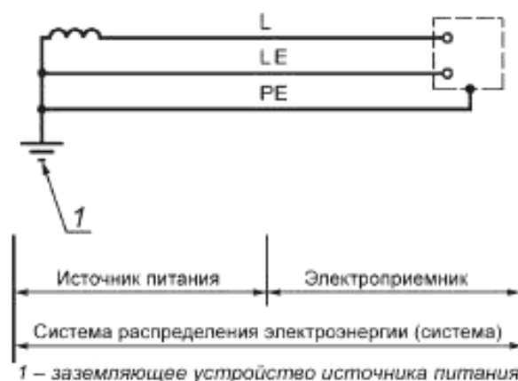
Рисунок 20.3 – Система распределения электроэнергии наименьшего размера
