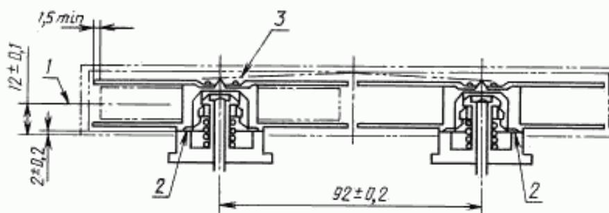
1 — центр магнитной ленты; 2 — высота основания сердечника катушки от базовой плоскости; 3 — прижимная пружина
