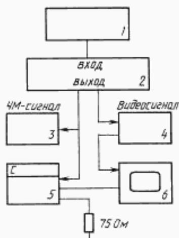
1 — генератор телевизионных сигналов; 2 — видеомагнитофон измерительный; 3 — осциллограф; 4 — измеритель отношения сигнал/шум; 5 — счетчик выпадений сигнала; 6 — видеоконтрольное устройство
