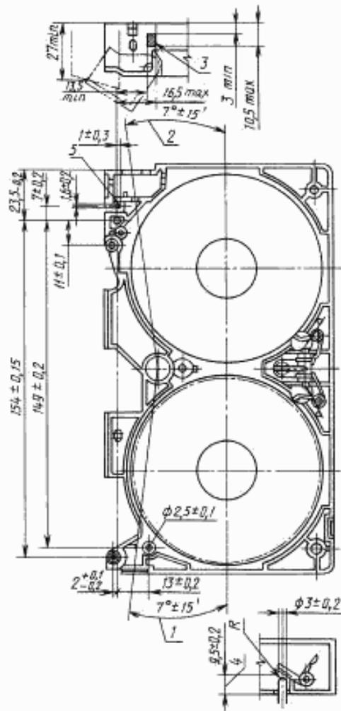
1 — угол падения света сенсорного датчика на стороне подающей катушки; 2 — угол падения света сенсорного датчика на стороне принимающей катушки; 3 — положение толкателя, открывающего (разблокирующего) защитную крышку видеокассеты; 4 — положение штифта толкателя видеомagnetofона, освобождающего (разблокирующего) узел стопорения видеокассеты; 5 — положение рычага (толкателя) видеомagnetofона для открывания защитной крышки видеокассеты.
