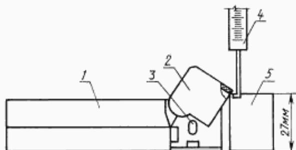
1 — видеокассета; 2 — защитная крышка; 3 — защелка;
