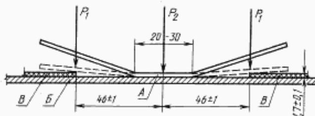
A — горизонтальная поверхность пружины; B — опорная поверхность;
