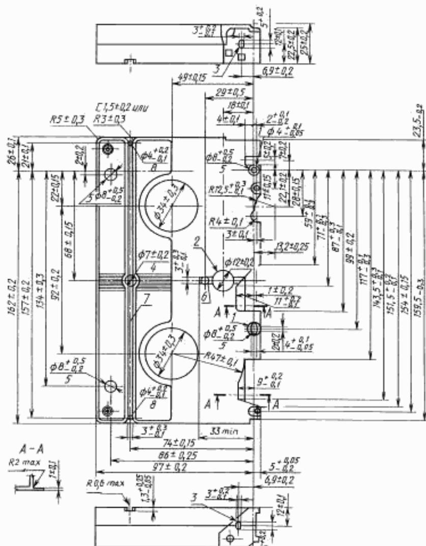
1 — базовое отверстие; 2, 3 — отверстия для прохождения света сенсорного датчика; 4 — отверстие для освобождения тормоза катушки; 5 — опорные поверхности. Отклонение от плоскости опорных поверхностей не должно быть более 0,2 мм; 6, 7 — направляющий паз для предотвращения неправильной установки видеокассеты в видеомэгнитофон; 8 — положение вспомогательного отверстия.
