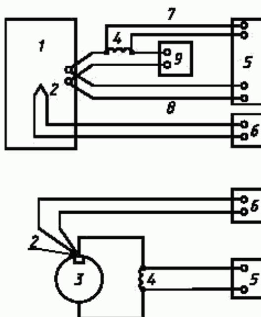
1 — образец; 2 — температурный датчик; 3 — контрольный элемент; 4 — прецизионный резистор; 5 — измерительный прибор; 6 — регистратор температуры; 7 — цепь измерения тока; 8 — цепь измерения напряжения; 9 — переменная нагрузка (предпочтительно электронная)
