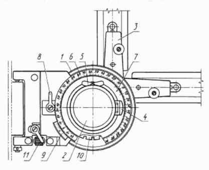
I— чертежная толовка; Z— ручка;  $\beta$ — держатель масштабной линейки;  $\delta$ — рычаг фиксации стопорного диска;  $\delta$ — рычаг фиксации произвольного угла;  $\delta$ — основная шкала;  $\delta$ — нониус;  $\delta$ — рычаг фиксации дополнительного поворота;  $\delta$ — изниус дополнительного поворота;  $\delta$ — стопорный диск;  $\delta$ — регулятор точной изстройки
