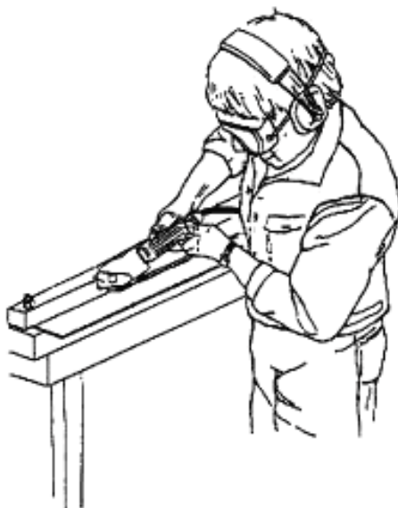
Рисунок 19 — Рабочая поза оператора, работающего дисковой пилой
