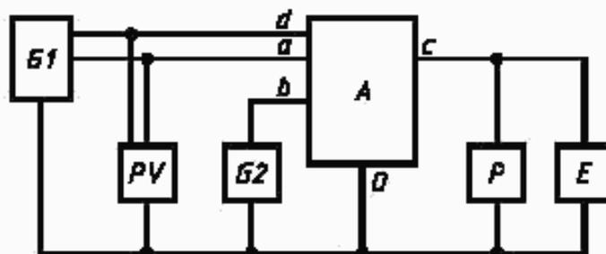
*E1* — источник постоянного напряжения; *PV* — измеритель постоянного напряжения; *G2* — генератор гармонического сигнала; *A* — схема управления импульсным стабилизатором напряжения; *a* — вход коммутируемого напряжения; *d* — вход «питания» микросхемы; *b* — вход гармонического сигнала; *c* — выход; *O* — общий вывод; *P* — измеритель времени нарастания и времени спада; *E* — нагрузка
