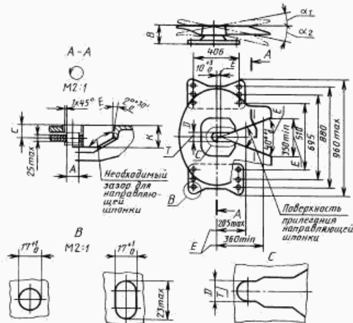
Примечание.  $E$  — рекомендуемые размеры;  $T$  — размер для двухзахватного седельно-сцепного устройства выбирается конструктивно.
