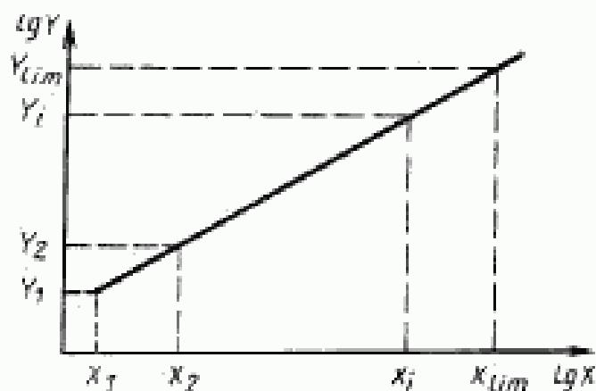
кают перпендикуляр, который на оси абсцисс указывает на расчетный пробег  $x_{lim}$  до предельно допустимого износа.
