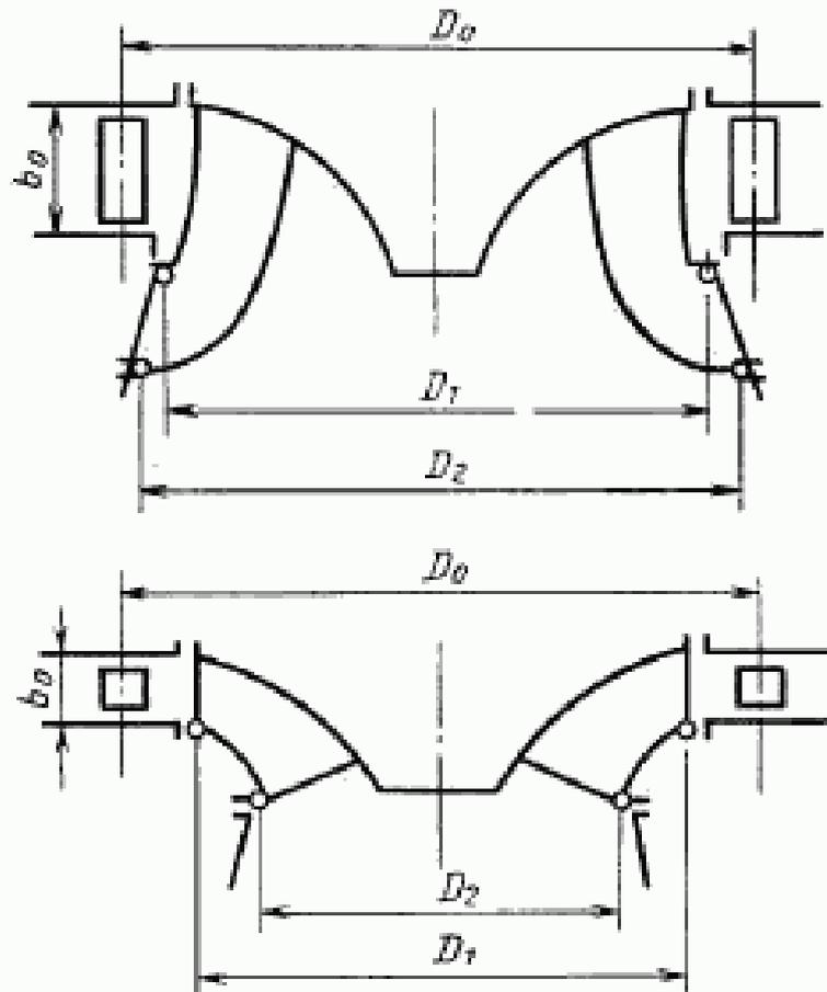
$D_0$  — диаметр окружностей расположения осей поворота лопаток направляющего аппарата;  $D_1$  — номинальный диаметр рабочего колеса (наибольший диаметр по входным кромкам рабочего колеса);  $D_2$  — наибольший диаметр рабочего колеса по выходным кромкам;  $b_0$  — высота направляющего аппарата
