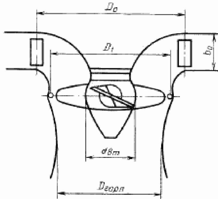
$D_0$  — диаметр окружностей расположения осей поворота лопаток направляющего аппарата;  $D_1$  — номинальный диаметр рабочего колеса (диаметр окружности, проведенный через точки пересечения осей поворота лопастей с камерой рабочего колеса);  $D_{горл}$  — диаметр горловины камеры рабочего колеса;  $d_{вт}$  — диаметр втулки;  $b_0$  — высота направляющего аппарата
