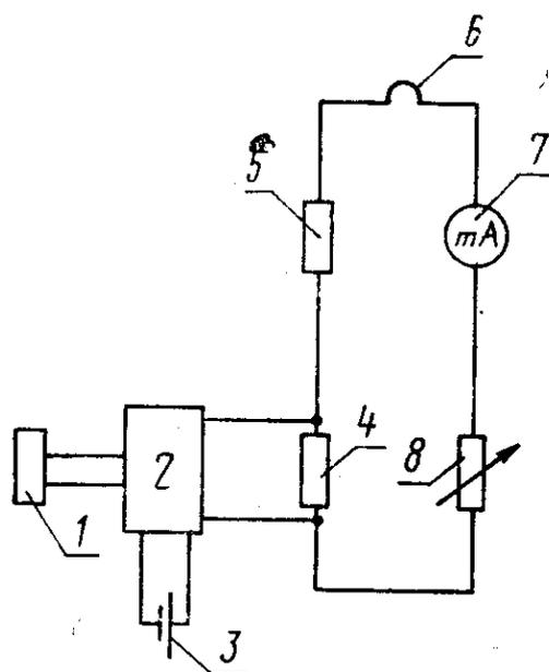
1, 5—стабилизатор напряжения П-36—1; 2—потенциометр Р363—2; 3—нормальный элемент НЭ-65; 4—образцовая катушка сопротивления, 10 Ом; 6—нагреватель калориметра; 7—миллиамперметр 0—50 мА; 8—магазин сопротивлений Р33
