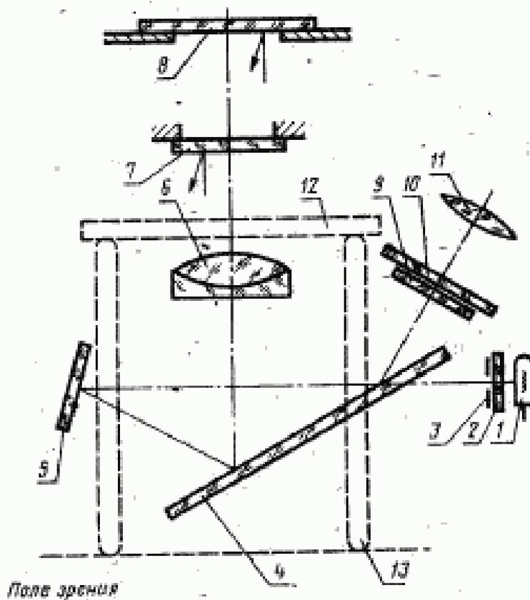
1—источник света; 2—молочное стекло; 3—маска; 4—полупрозрачное зеркало; 5—зеркало; 6—объектив; 7—светоделительное зеркало; 8—прижимное стекло; 9—мишениый экран; 10—измерительная сетка; 11—вспомогательная лупа; 12—контрольное зеркало; 13—опорные стойки
