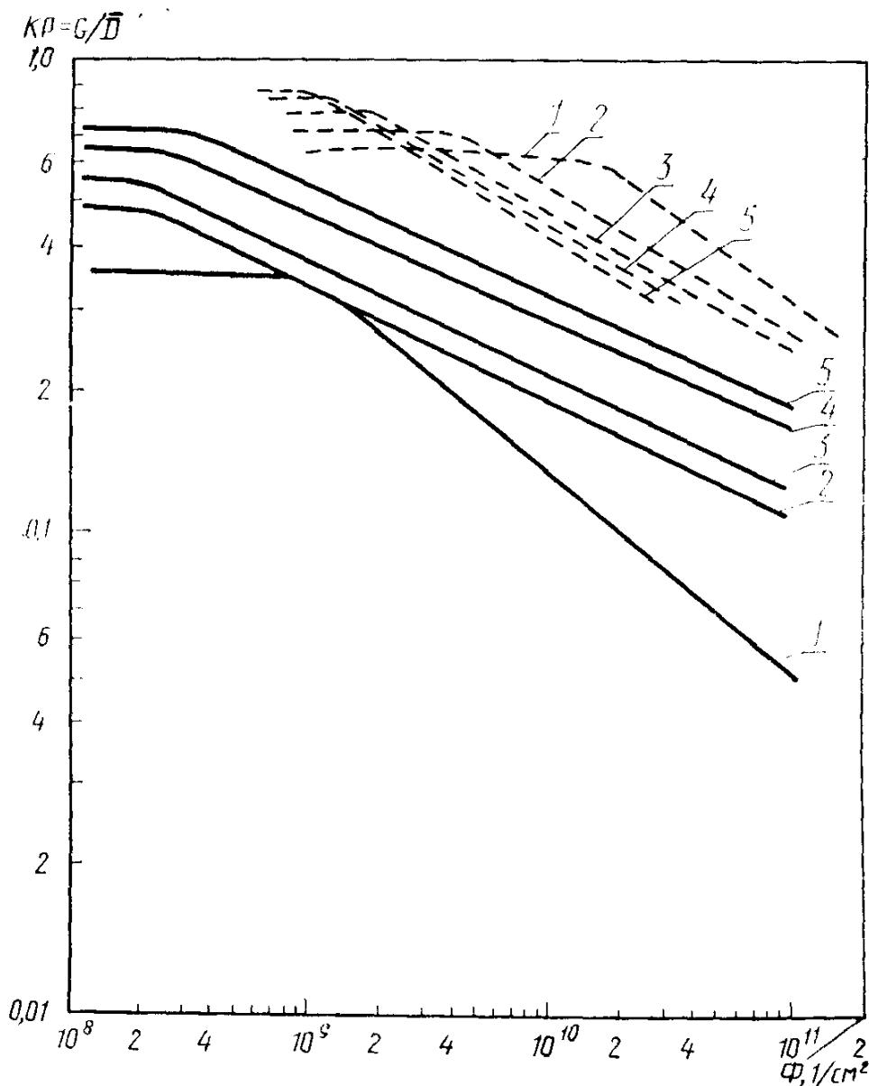
Примечание. Кривые 1, 2, 3, 4 и 5 для спектров протонов с характеристикой жесткостью, равной соответственно 50, 80, 100, 150 и 200 МВ. Сплошные кривые для толщины защиты 1 г/см<sup>2</sup>, пунктирные для 6 г/см<sup>2</sup>.
