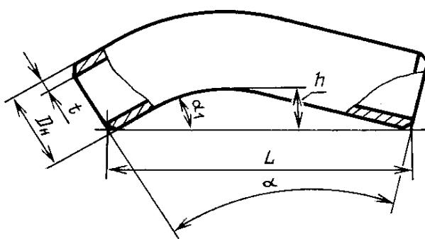
$t$  — толщина стенки отвода (принимается по толщине стенки трубы);  $D_h$  — диаметр отвода (принимается по наружному диаметру трубы);  $\alpha$  — угол гибки отвода;  $\alpha_1$  — угол между хордой и прямым участком трубы со стороны которого была начата ее гибка;  $L$  — длина хорды между концами отвода;  $h$  — высота стрелки (максимальная) от хорды до внутренней образующей отвода
