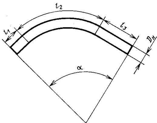
$D_n$  — наружный диаметр отвода;  $\alpha$  — угол гибки отвода;
