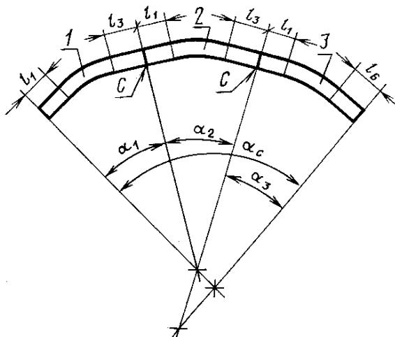
$l_1, l_2, l_3$  — отводы;  $l_1, l_3, l_6$  — прямые концы отводов;  $C$  — поперечный сварной шов, соединяющий гнутые отводы;
