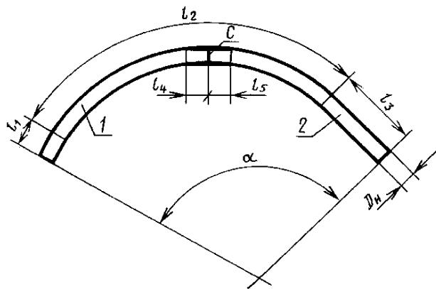
$l_1$ ,  $l_2$  — трубы, образующие отвод;  $D_n$  — наружный диаметр отвода;  $l_3$  — прямые концы отвода;  $l_2$  — гнутая часть отвода;  $l_4$ ,  $l_5$  — прямые участки труб у поперечного сварного шва;  $C$  — поперечный сварной шов, соединяющий трубы
