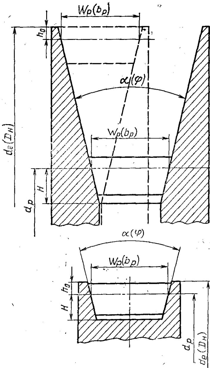
$de(D_H)$  — наружный диаметр шкива;  $d_p$  — расчетный диаметр шкива
