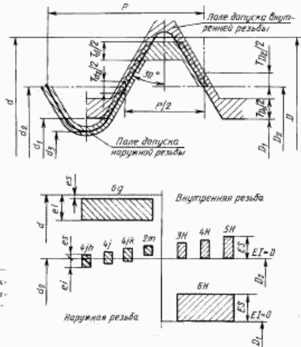
$e_i$  — нижнее отклонение диаметров наружной резьбы;  $E_i$  — нижнее отклонение диаметров внутренней резьбы;  $e_s$  — верхнее отклонение диаметров наружной резьбы;  $E_s$  — верхнее отклонение диаметров внутренней резьбы;  $T$  — допуск диаметров резьбы (диаметр резьбы дается в индексе)
