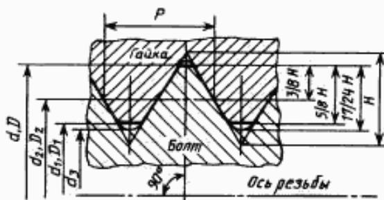
$d$  — наружный диаметр наружной резьбы (болта);  $D$  — наружный диаметр внутренней резьбы (гайки);  $d_2$  — средний диаметр болта;  $D_2$  — средний диаметр гайки;  $d_1$  — внутренний диаметр болта;  $D_1$  — внутренний диаметр гайки;  $d_3$  — внутренний диаметр болта по дну впадины;  $P$  — шаг резьбы;  $H$  — высота исходного треугольника
