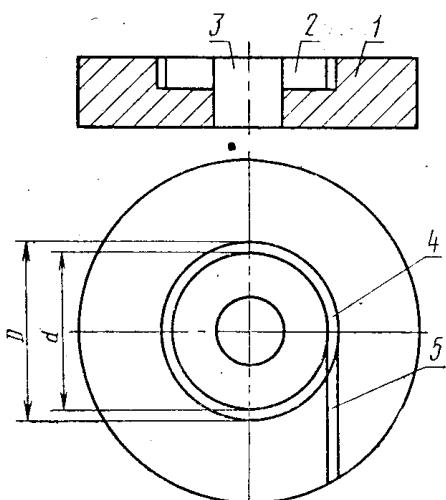
Наружный диаметр рулона пленки марки КЭ толщиной 3 мкм — от 125 до 225 мм, для пленки толщиной выше 3 мкм — от 135 до 225 мм. По требованию потребителя допускается намотка пленки в рулоны другого наружного диаметра.
