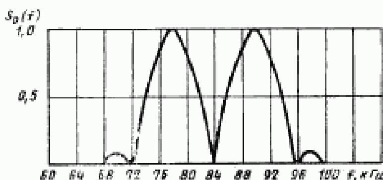
На чертеже показано формирование спектра амплитуд линейного сигнала данных в УПС-48 ПШ.
