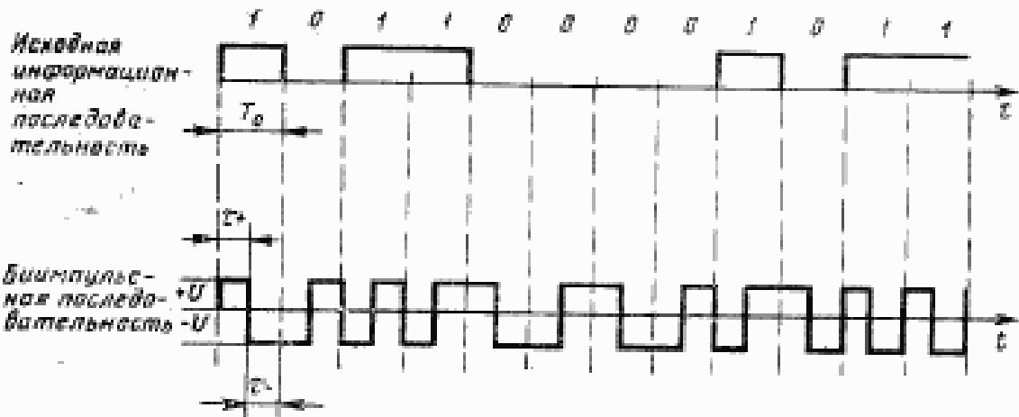
$T_p$  — длительность положительного импульса бимпульса;  $T_n$  — длительность отрицательного импульса бимпульса;  $T_p = T_n = T_0 / 2$ , где  $T_0$  — единичный интервал;
