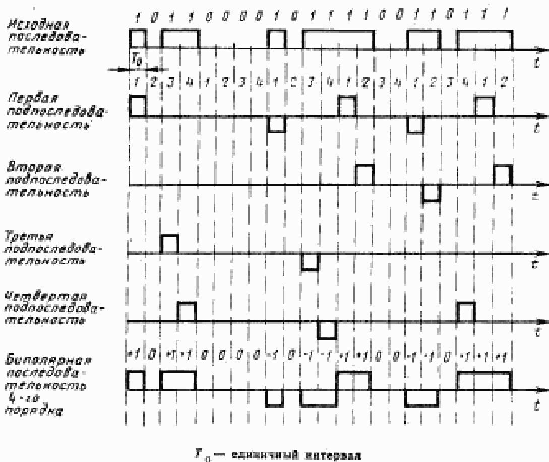
На чертеже изображена временная диаграмма преобразования исходной информационной последовательности двоичных символов в биполярную последовательность четвертого порядка, передаваемой со скоростями 48 кбит/с и 64 кбит/с.
