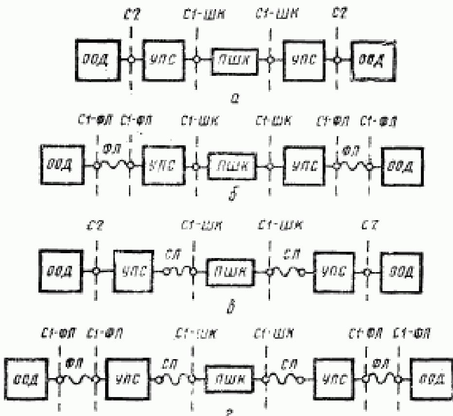
а—УПС сопрягается с ООД по цепям стыка Ст и с ПШК по цепям стыка Ст (Ст-ШК) при непосредственном сопряжении УПС с ПШК; б—УПС сопрягается с ООД по цепям стыка Ст—ФЛ при управлении от ООД и с ПШК по цепям стыка Ст-ШК; в—УПС сопрягается с ООД по цепям стыка Ст и с ПШК с помощью СЛ; г—УПС сопрягается с ООД по стыку Ст—ФЛ и с ПШК с помощью СЛ.
