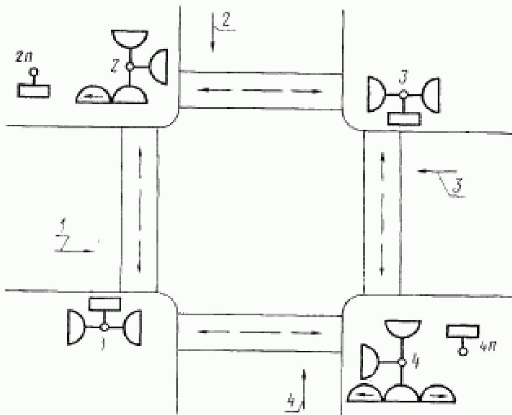
*1—4*—номера светофорной установки, а также угла перекрестка в плане; *1—4* (на полке-выноске)—направление движения транспортных средств; *2П*, *4П*—номер отдельно стоящего пешеходного светофора
