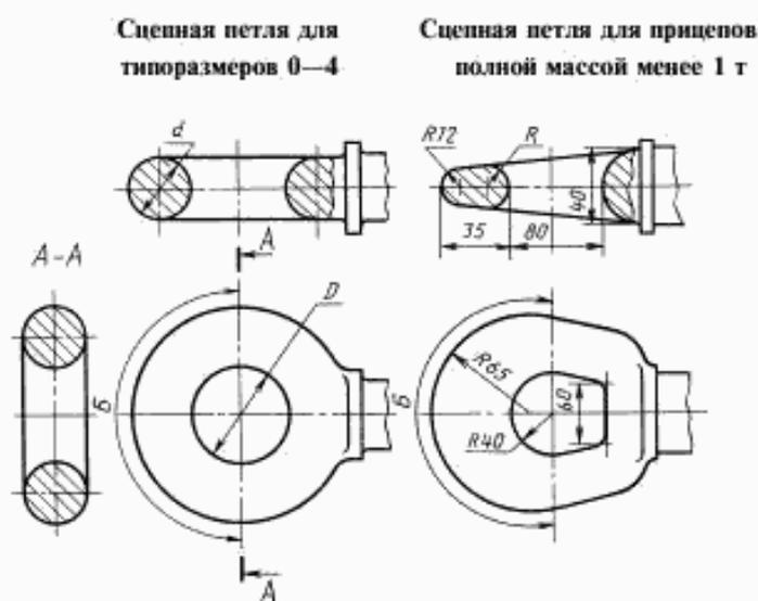
Присоединительные размеры сцепной петли для прицепов, технические задания на которые утверждены после 01.01.87, буксируемые тяговыми крюками типоразмеров 2 и 3
