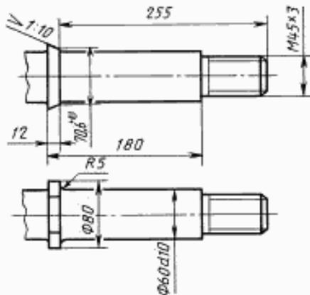
Допуски и точность изготовления — Т2 по ГОСТ 7505.
