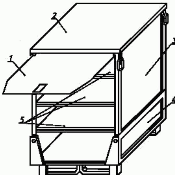
1 — торцовая стенка; 2 — крышка; 3 — боковая стенка; 4 — основание; 5 — полки
