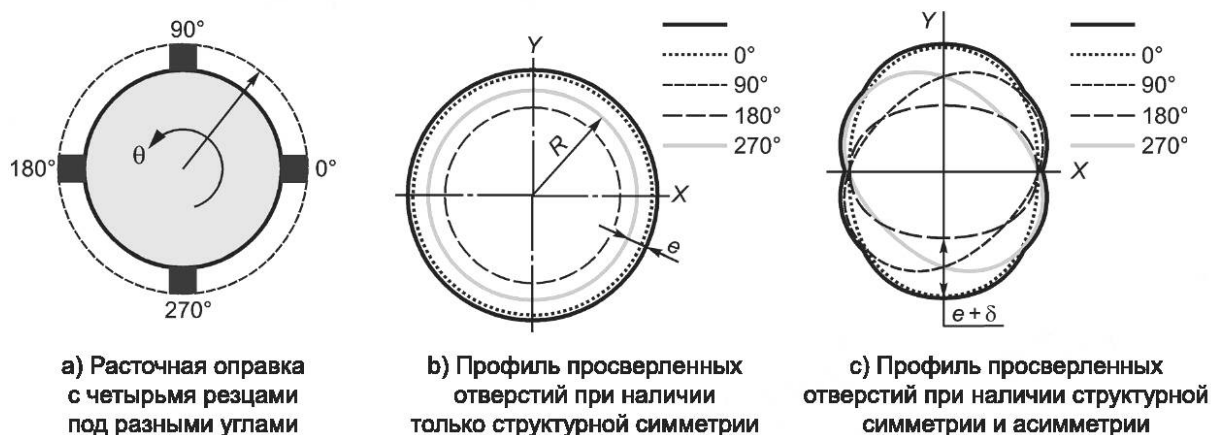
Рисунок А.12 — Профили отверстий для многоинструментальной расточной оправки при наличии структурной симметрии и структурной асимметрии
