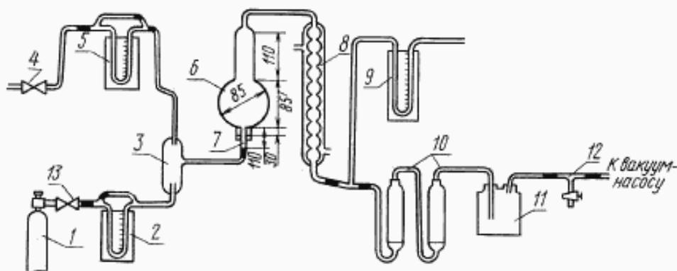
1 — пробоотборник; 2, 5 — реометры; 3 — смеситель; 4, 13 — редукционный или игольчатый вентиль; 6, 8 — лимповое стекло с приваянным к нему холодильником; 7 — горелка; 9 — манометр; 10 — поглотители; 11 — предохранительная склянка; 12 — тройник
