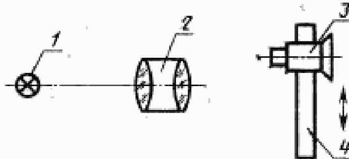
1—диффузно излучающий источник света; 2—испытуемый объектив; 3—микроскоп; 4—поперечные направляющие с кареткой, несущей микроскоп
