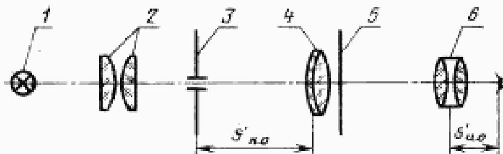
1—источник; 2—конденсор; 3—диафрагма с малым отверстием диаметра (0,1—0,3) мм; 4—объектив коллиматора; 5—приспособление с вертикальной нитью; 6—испытуемый объектив
