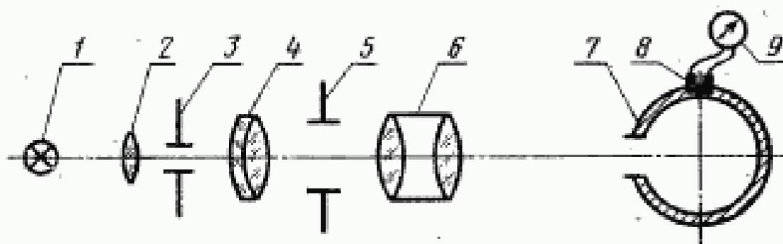
1—источник света; 2—конденсор; 3—коллиматорная диафрагма; 4—объектив коллиматора; 5—диафрагма с калиброванным отверстием; 6—испытуемый объектив; 7—фотометрический шар; 8—фотоприменник; 9—отсчетное устройство
