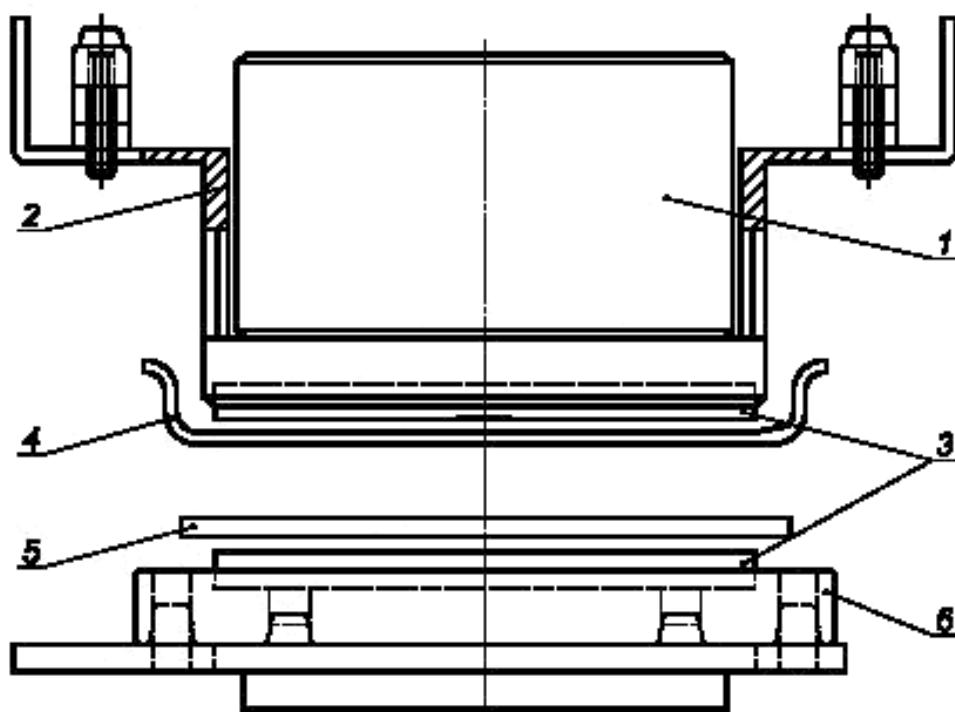
**П р и м е ч а н и е** — Рисунок иллюстрирует проекцию (сторону) аппарата для получения отпечатков (см. 5.10).
