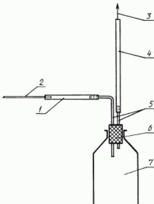
1 — трубка ПЭНД  $d_y = 6$  мм,  $l = 600-700$  мм; 2 — острый наконечник для отбора пробы из мешка (титан или нержавеющая сталь  $d_y = 5$  мм,  $l = 150$  мм); 3 — к вакуум-насосу; 4 — трубка ПЭНД  $d_y = 6$  мм; 5 — трубка из титана или нержавеющей стали  $d_y = 6$  мм; 6 — пробка резиновая; 7 — бутылка или колба из толстостенного стекла вместимостью 1—2 дм<sup>3</sup>
