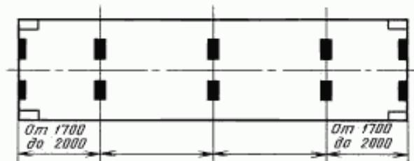
б) при 6 парах опорных (контактных) площадок
