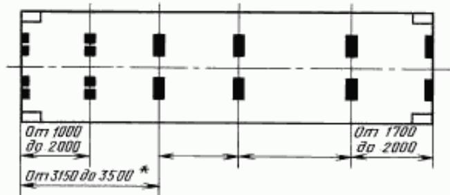
б) при 7 парах опорных (контактных) площадок
