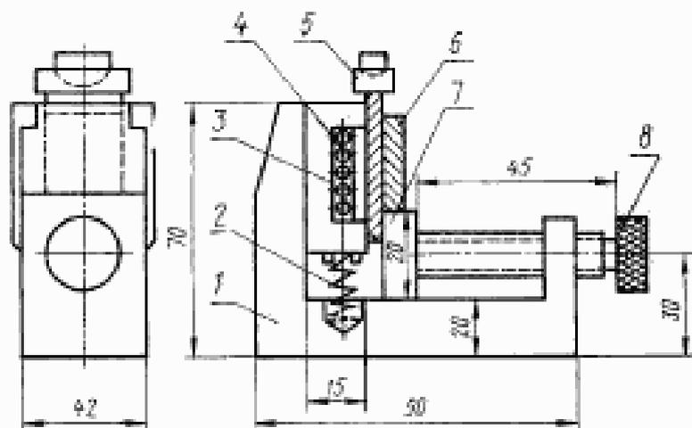
1 — корпус; 2 — пружина; 3 — подвижная планка; 4 — ролики; 5 — съемная нажимная призма с шаровой опорой; 6 — образец; 7 — подвижная опора; 8 — прижимной винт.
