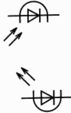
2. Взаимная ориентация обозначений источника и приемника не устанавливается, а определяется удобством вычерчивания схемы, например:
