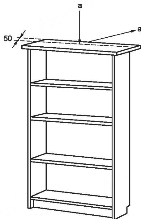
б) Вертикальная и горизонтальная нагрузки на расстоянии 50 мм от заднего края
