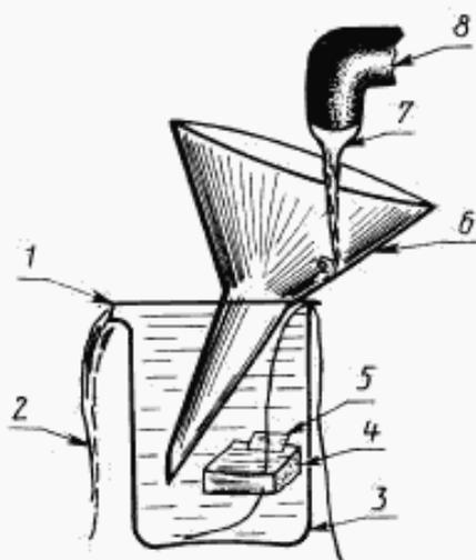
1 — носик стакана; 2 — вытекающие промывные воды; 3 — стеклянный стакан; 4 — проба, наизанная на нитку; 5 — этикетка пробы; 6 — лабораторная воронка; 7 — слабая струйка воды; 8 — водопроводный кран
