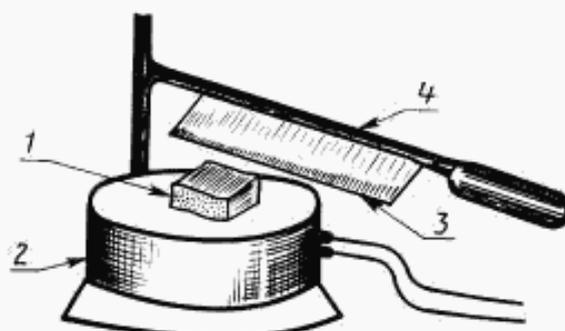
1 — проба; 2 — микротом; 3 — лезвие ножа; 4 — микротомный нож
