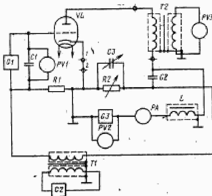
VL—испытываемая лампа; T1, T2—трансформаторы; G1, G2—источники постоянного напряжения; G3—генератор синусоидального напряжения; R1, R2—безындукционные резисторы; C1, C2—конденсаторы; C3—компенсирующий конденсатор; PV1, PV2—вольтметры; PV3—милливольтметр; PA—миллиамперметр; L—дроссель.
