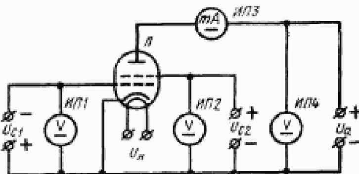
ИП1, ИП2, ИП4—вольтметры постоянного тока; ИПЗ—миллиамперметр постоянного тока; Л—испытываемая лампа.
