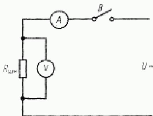
$R_{изм}$  — измеряемое сопротивление; А — амперметр; V — вольтметр; В — выключатель
