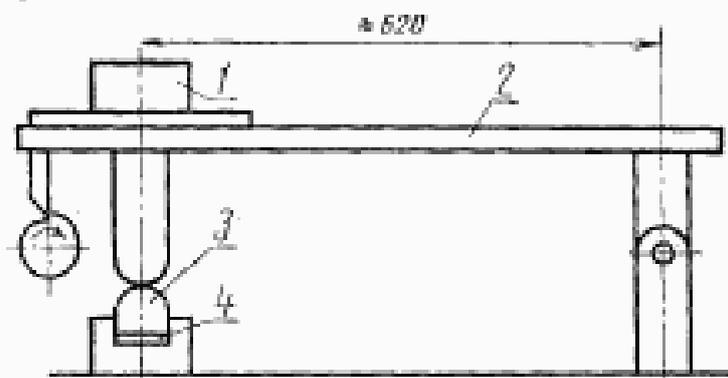
1—испытуемый электромагнит; 2—стальная плита; 3—стальной буфер; 4—резиновая плита
