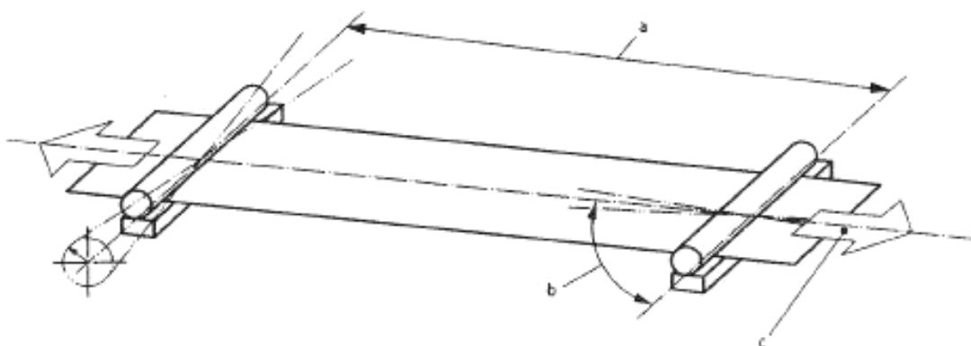
а – линии зажимов образца, параллельных между собой с предельным отклонением  $\pm 1^\circ$ ;
