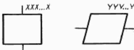
4.1.7 В схемах работы системы символы, отображающие носители данных, во многих случаях представляют способы ввода-вывода. Для использования в качестве ссылки на документацию текст на схеме для символов, отображающих способы вывода, должен размещаться справа над символом, а текст для символов, отображающих способы ввода, — справа под символом.
