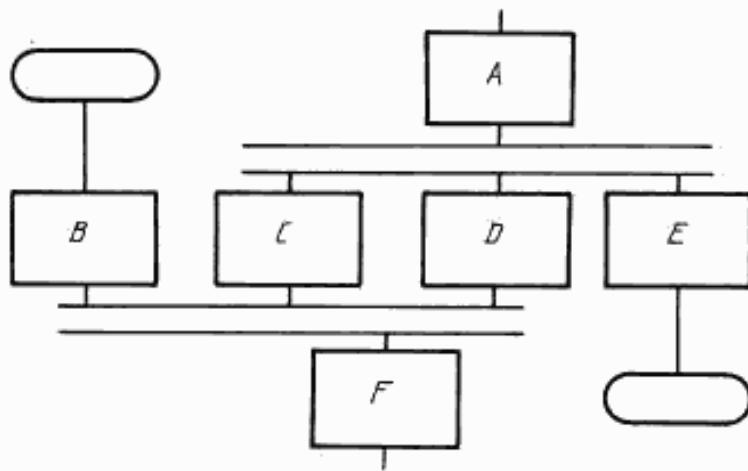
**П р и м е ч а н и е.** Процессы С, Д и Е не могут начаться до тех пор, пока не завершится процесс А; аналогично процесс F должен ожидать завершения процессов В, С и Д; однако процесс С может начаться и (или) завершиться прежде, чем соответственно начнется и (или) завершится процесс Д.
