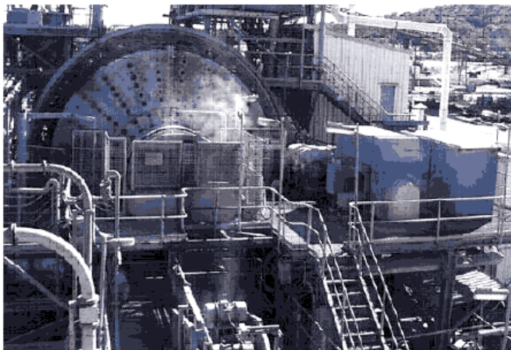
Рисунок С.1 – Рудоразмольная шаровая мельница с механизмом привода
