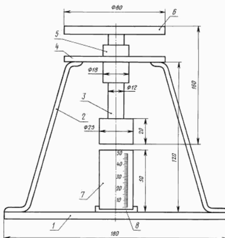
1 — основание прибора; 2 — стойка; 3 — плунжер со штоком; 4 — диск для крепления ступки; 5 — направляющая стойка; 6 — площадка для груза; 7 — цилиндр; 8 — подставка под цилиндр
