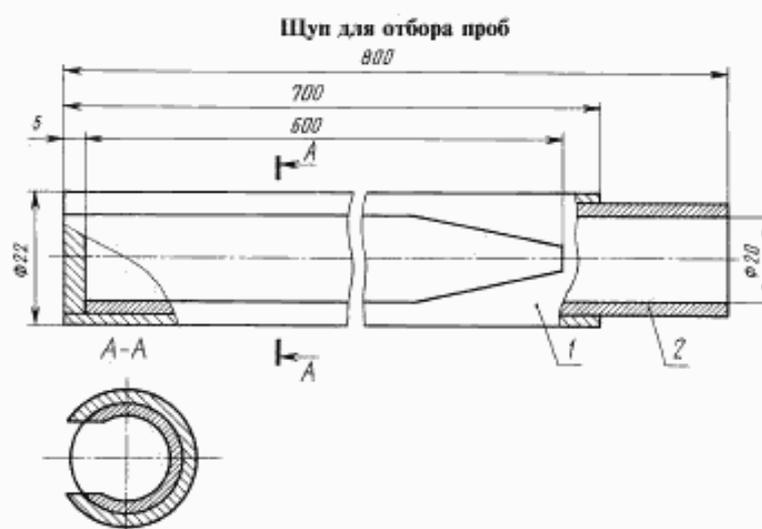
1 — внешняя трубка; 2 — внутренняя трубка
