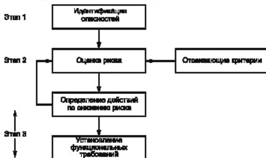
Рисунок 2 – Схема процесса управления риском
