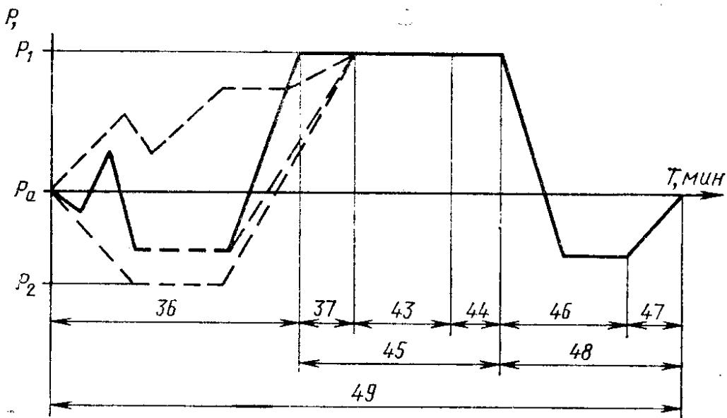
$P_a$  — атмосферное давление, Па;  $P_1$  — давление пара при температуре стерилизации, Па;  $P_2$  — вакуум по заданной программе, Па; — изменение давления в точках полезного объема наиболее труднодоступных для стерилизующего агента
