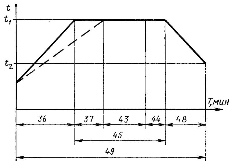
$t_1$ —температура стерилизации,  $^{\circ}\text{C}$ ;  $t_2$ —температура охлаждения,  $^{\circ}\text{C}$ ;  $t_3$ —изменение температуры в точках полезного объема наиболее труднодоступных для стерилизующего агента
