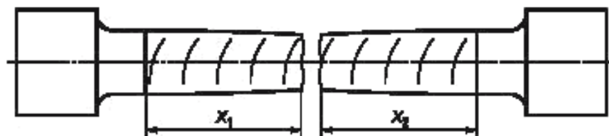
Рисунок 4 — Область проверки L в образце для испытания на растяжение металла шва
