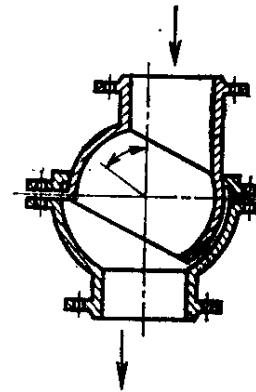
29. Шаровое соединение пульпопровода
