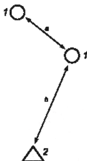
1 — пункт подвижного приемника; 2 — опорный пункт; а — минимальное расстояние 2 м (не должно превышать 20 м); b — расстояние от опорной станции, соответствующее поставленной задаче
