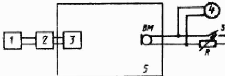
1 — низкочастотный генератор сигналов (п. 1.3.1); 2 — усилитель мощности (при необходимости); 3 — излучатель (п. 1.11.2); ВМ — испытуемый микрофон; R — магазин сопротивлений (п. 1.29); 4 — вольтметр (п. 1.4); S — переключатель; 5 — помещение, обеспечивающее условия свободного поля (п. 2.3.1)
