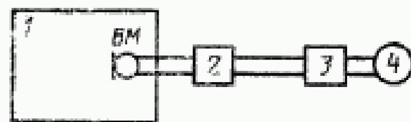
1 — устройство «звукоизолированная камера» (п. 1.22); 2 — измерительный усилитель (п. 1.3); 3 — фильтр с частотной характеристикой А (п. 1.3); 4 — вольтметр (п. 1.3); BM — испытуемый микрофон
