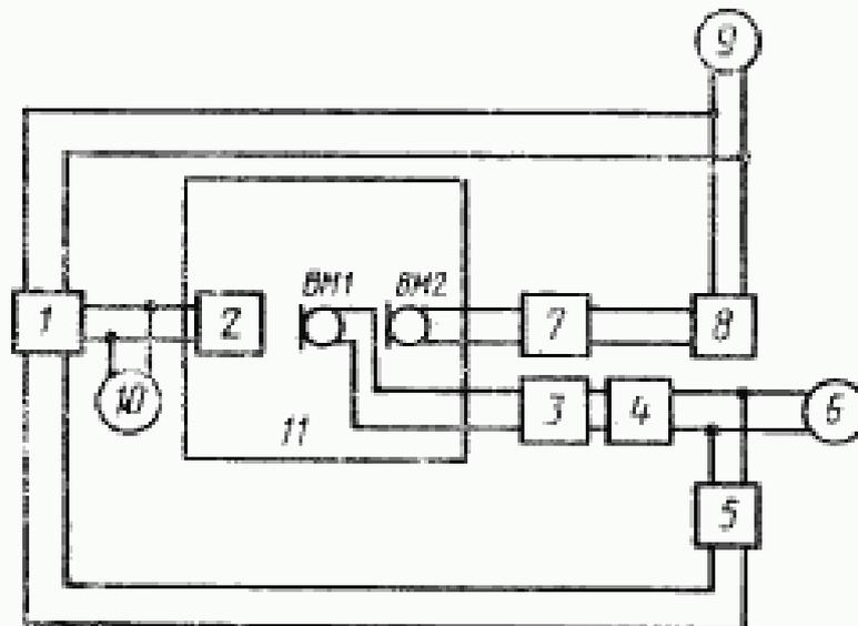
1 — установка УАЗНХ (п. 1.2); 2 — излучатель (п. 1.11.2); BM1 — управляющий микрофон (п. 1.11.3); BM2 — измерительный (по 1.12, 1.13) или испытуемый микрофон; 3, 7 — измерительные усилители (п. 1.3); 4, 8 — сопровождающие избирательные фильтры (п. 1.9) (при необходимости); 5 — устройство автоматического регулирования (п. 1.11.1); 6, 9, 10 — вольтметры (п. 1.4); 11 — помещение, обеспечивающее условия свободного поля (п. 2.3.1)
