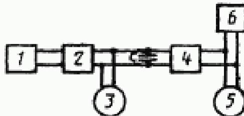
1 — низкочастотный генератор сигналов (п. 1.21); 2 — усилитель мощности (при необходимости); 3 — конденсатор с емкостью, равной емкости капсуля; 4 — ПУ — предварительный усилитель микрофона; 5, 5 — вольтметр (п. 1.4) (при необходимости); 6 — анализатор спектра (п. 1.5)
