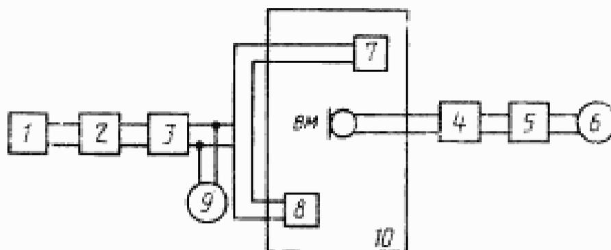
1 — низкочастотный генератор шумовых сигналов (п. 1.2.2); 2, 5 — третьоктавные фильтры (п. 1.8); 3 — усилитель мощности (при необходимости); 4 — измерительный усилитель (при необходимости) (п. 1.3); 6, 9 — вольтметры (п. 1.); 7, 8 — излучатели (п. 1.11.2); ВМ — испытуемый или измерительный микрофон, отрадурированный по диффузному полю; 10 — помещение, обеспечивающее условия диффузного поля (п. 2.3.2)
