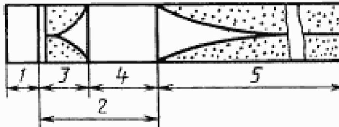
1 — секция с излучателем (п. 1.11.2); 2 — участок формирования плоской бегущей волны; 3 — дополнительный звукопоглощающий конус; 4 — рабочая часть устройства; 5 — звукопоглощающая конструкция.
