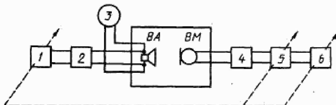
1 — генератор ГНИ; 2 — усилитель мощности У1; 3 — электронный вольтметр; 4 — микрофонный усилитель УМ; 5 — следящий анализатор спектра; 6 — регистрирующее устройство; BA — контролируемый громкоговоритель; BM — измерительный микрофон
