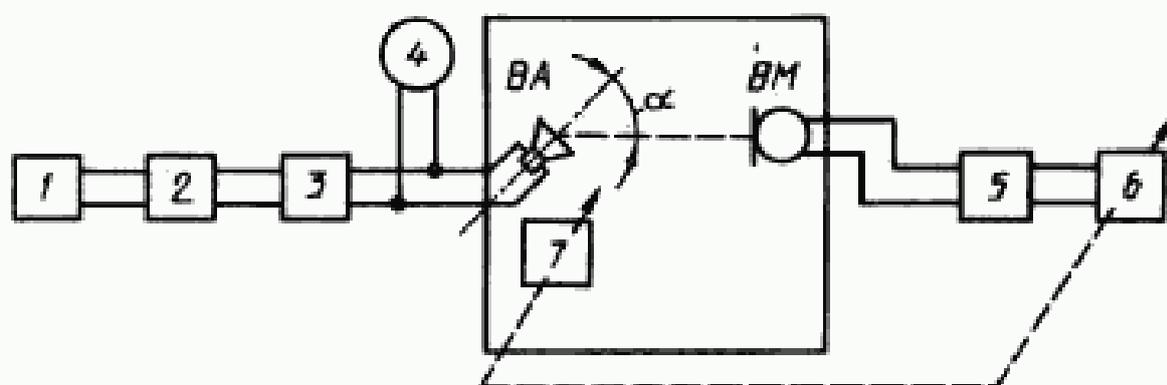
1 — генератор ГИИ; 2 — полосовой третьоктавный или октавный фильтр; 3 — усилитель мощности У1; 4 — электронный вольтметр; 5 — микрофонный усилитель УМ; 6 — регистрирующее устройство; 7 — поворотный стол; ВА — контролируемый громкоговоритель; ВМ — измерительный микрофон
