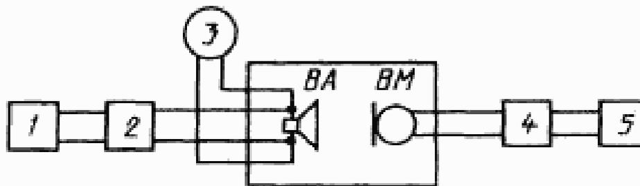
1 – генератор ГНИ; 2 – усилитель мощности У1; 3, 5 – электронный вольтметр; 4 – микрофонный усилитель УМ; ВА – контролируемый громкоговоритель; ВМ – измерительный микрофон
