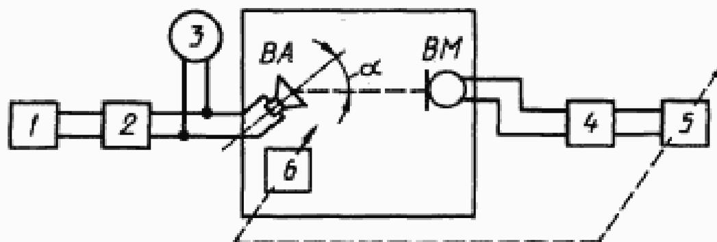
1 — генератор ГНИ; 2 — усилитель мощности У1; 3 — электронный вольтметр;
