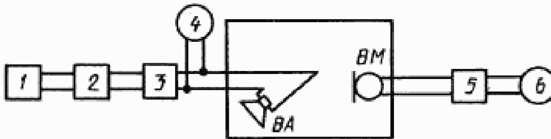
1 – генератор ГШН; 2 – полосовой третьоктавный или октавный фильтр; 3 – усилитель мощности У1; 4, 6 – электронные вольтметры; 5 – микрофонный усилитель УМ; BM – измерительный микрофон; BA – контролируемый громкоговоритель
