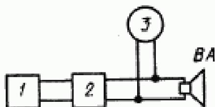
1 – генератор ГНИ; 2 – усилитель мощности У1; 3 – электронный вольтметр; ВА – контролируемый громкоговоритель
