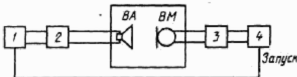
1 — генератор ГДС; 2 — усилитель мощности У1; 3, 5 — электронный вольтметр; 4 — микрофонный усилитель УМ; ВА — контролируемый громкоговоритель; ВМ — измерительный микрофон
