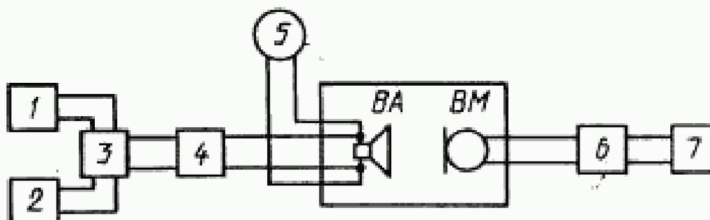
1 и 2 — генераторы ГНИ; 3 сумматор; 4 усилитель мощности У1;
