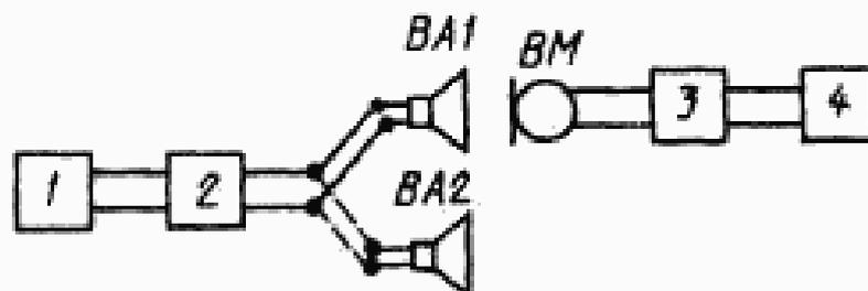
1 – импульсный генератор; 2 – усилитель мощности У1 или У2;
