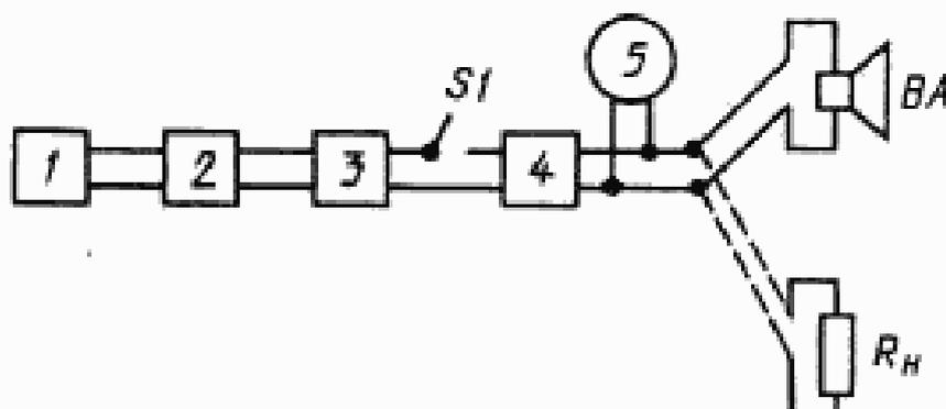
1 – генератор белого или розового шума; 2 – фильтр ФПШМ; 3 – фильтр ФЭД; 4 – усилитель мощности У2; 5 – электронный вольтметр; BA – контролируемый громкоговоритель;  $R_H$  – резистор;  $S_1$  – прерыватель
