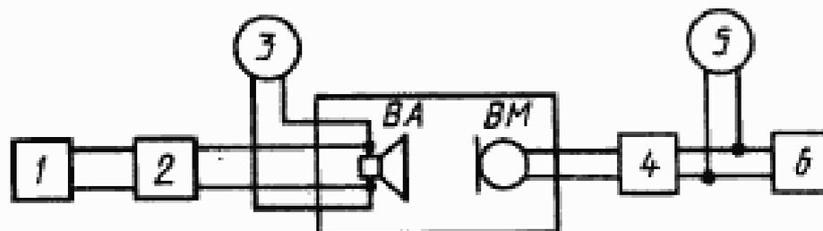
1 – генератор ГНИ; 2 – усилитель мощности У1; 3, 5 – электронные вольтметры; 4 – микрофонный усилитель УМ; 6 – селективный вольтметр или анализатор спектра; BA – контролируемый громкоговоритель; BM – измерительный микрофон
