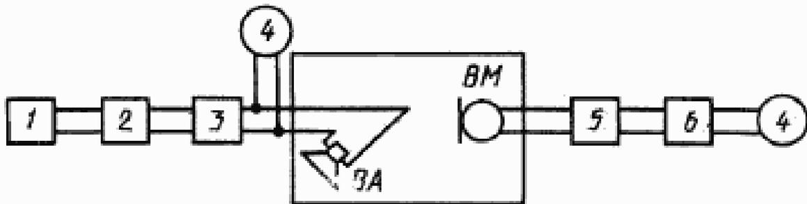
1 – генератор ГШН (розовый шум); 2 – полосовой третьоктавный фильтр; 3 – усилитель мощности У1; 4 – электронный вольтметр; 5 – микрофонный усилитель УМ; 6 – полосовой третьоктавный фильтр со средней номинальной частотой полосы пропускания, кратной средней номинальной частоте полосы пропускания фильтра 2; BM – измерительный микрофон; BA – контролируемый громкоговоритель
