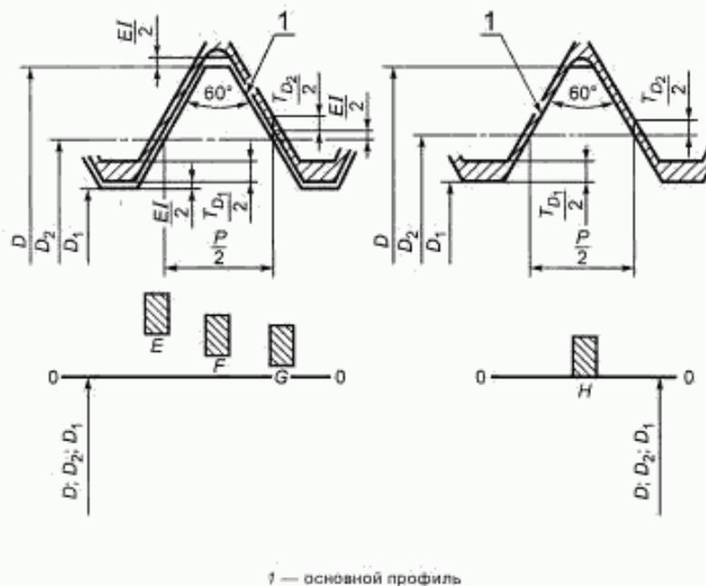
Рисунок 2 — Положения полей допусков внутренней резьбы
