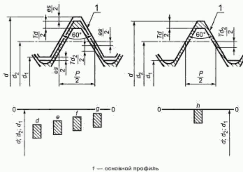
Рисунок 1 — Положения полей допусков наружной резьбы
