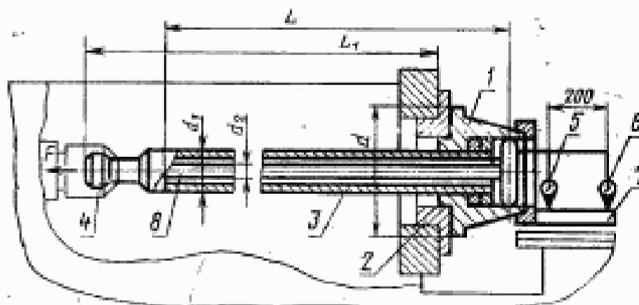
$d$  — диаметр опорной детали;  $d_1$  — диаметр нагрузочной оправки;
