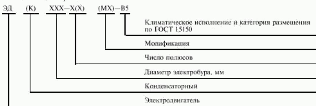
Пример условного обозначения типа электродвигателя конденсаторного для электробура диаметром 164 мм, числом полюсов 4, первой модификации, климатического исполнения В, категории размещения 5:
