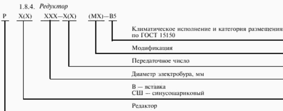
Пример условного обозначения типа редуктора синусошарикового для электробура диаметром 164 мм, с передаточным числом 10, первой модификации, климатического исполнения В, категории размещения 5:
