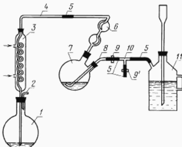
1 — колба-приёмник П-2—1000—42 ТС по ГОСТ 25336; 2 — трубка для сообщения с атмосферой; 3 — холодильник ХСН-16 по ГОСТ 25336 с удлиненной трубкой, доходящей почти до дна приемника; 4 — переходная трубка; 5 — резиновые трубки; 6 — двойной каллеулловитель КО-60 по ГОСТ 25336; 7 — колба для перегонки КГУ-2—2—1000—34 ТС по ГОСТ 25336; 8 — трубка для ввода пара; 9, 9' — винтовые зажимы; 10 — тройник; 11 — парообразователь
