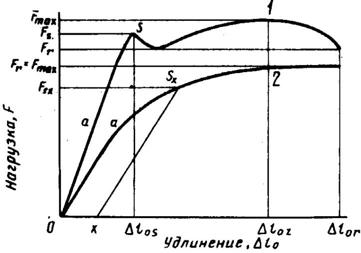
1—материал имеет предел текучести; 2—материал не имеет предела текучести;  $a$ —участки прямолинейного направления кривой в начале кривой «нагрузка—удлинение»;  $S$ —предел текучести;  $x$ —отрезок на оси удлинения для определения условного предела текучести;  $S_x$ —условный предел текучести.
